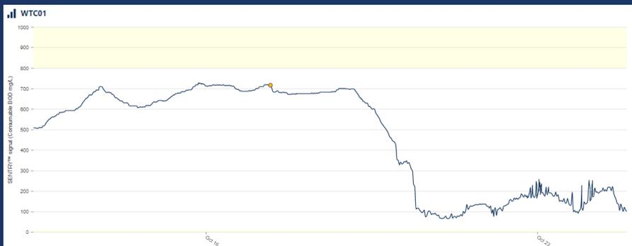
信号快速降低，可能的原因：毒性冲击，来水COD或BOD大幅度降低，B/C降低，含抑制性物质
