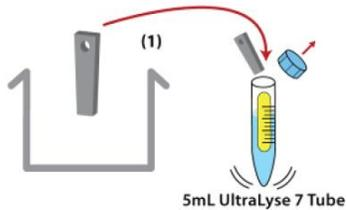
注: 当生物膜收集器上的残留液体被去除后, 请尽快进行测试。如不能及时测试, 请将收集器保存在同样环境的液体中直到测试之前。
