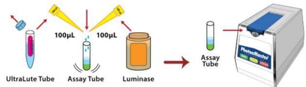
注: 如果PhotonMaster上显示的RLU<sub>tATP</sub> ≤ 10, 则已经低于设备的最低测量限值, 请在计算式中将tATP (ng ATP/mL) 记为0。
